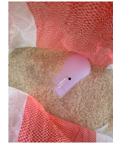
รูปที่ 4.2 Smart Capsule ในกระสอบข้าวสาร
